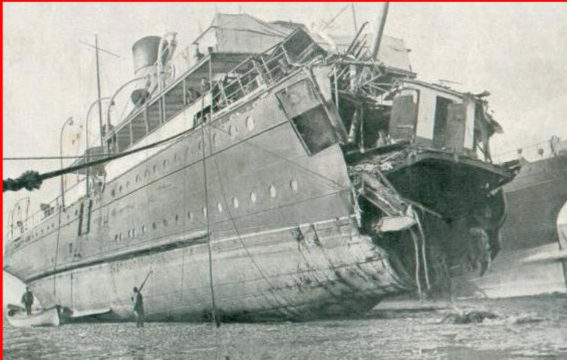
La coupure de l'avant du Sussex : vue prise après l'échouage dans le petit port de Boulogne-sur-Mer
